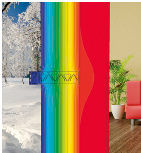
Abbildung 2 Minimale Wärmebrücke bei CROSSFIX®
