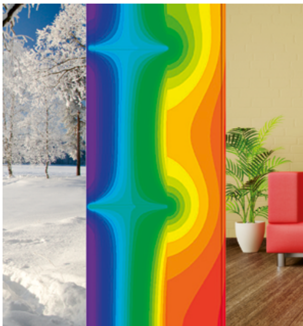
Abbildung 1 Ausgeprägte Wärmebrücke bei Aluminiumkonsolen
