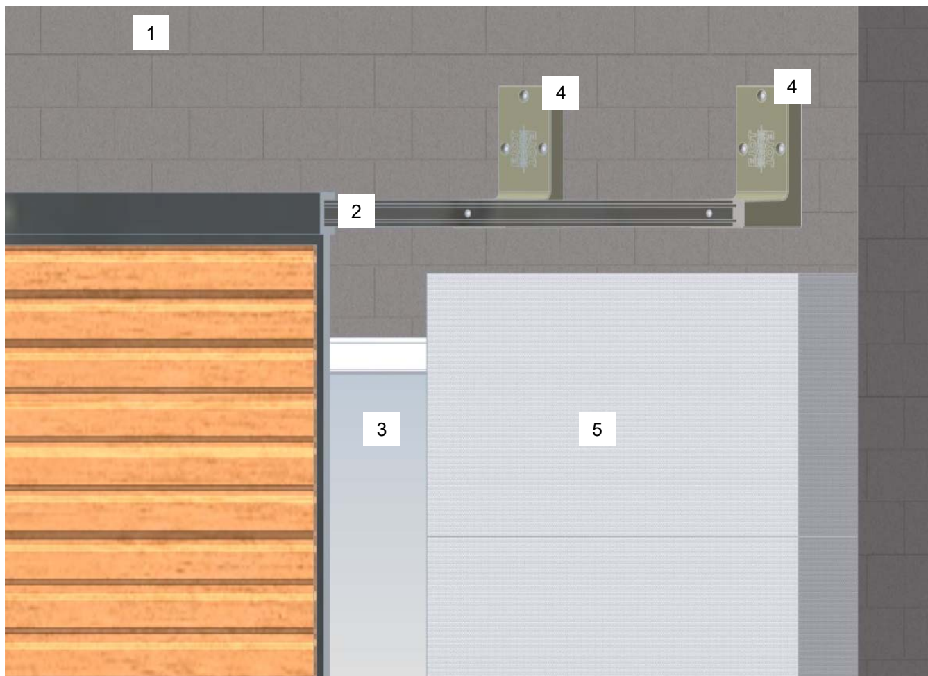
Darstellung 1: Beispiel Einbauzustand Schiebeladen – stirnseitige Montage
